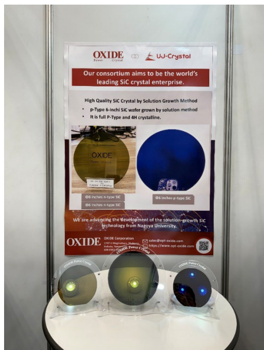
図1 展示品:6 インチ n 型ウエハ(左)、8 インチn型ウエハ(中)、6 インチp型ウエハ(右) (注4)
